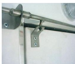
Управляемый вручную центральный замок боковых дверей.
